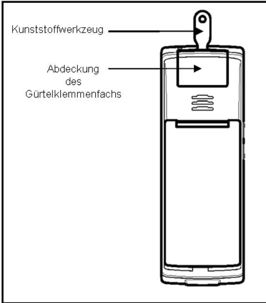
**Abb. 14: Verwendung des Kunststoffwerkzeugs**
