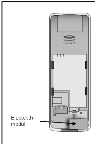
**Abb. 22: Entferntes Bluetooth-Modul**
