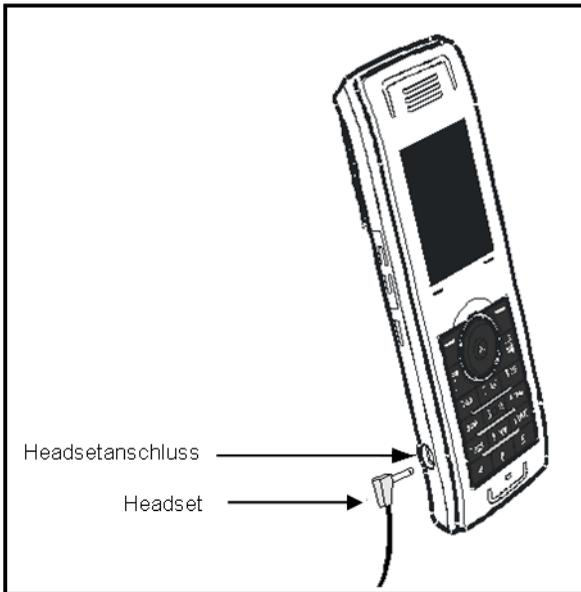
**Abb. 18: Das Headset anschließen**
