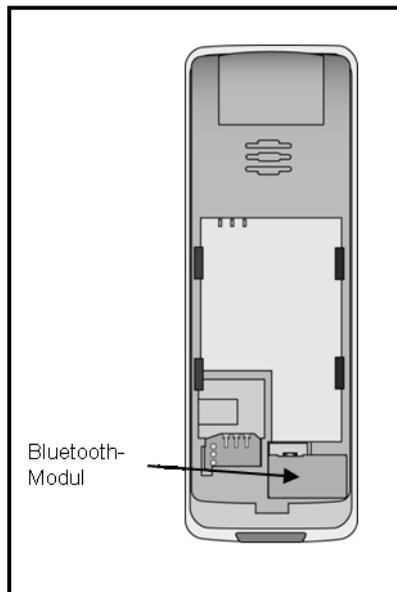
**Abb. 21: Installiertes Bluetooth-Modul**
