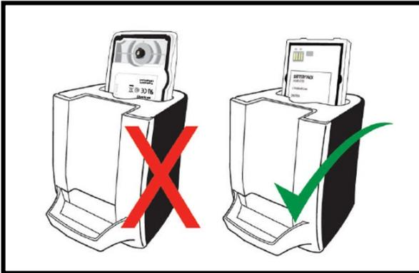
Abb. 4: Positionierung des I755 Ersatz-Akkus
